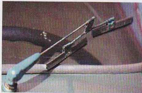
Wünschen statt wischen: Um 1947 wanderten die über der Scheibe montierten Wischerchen nach unten, was ihre Funktion kaum besserte
