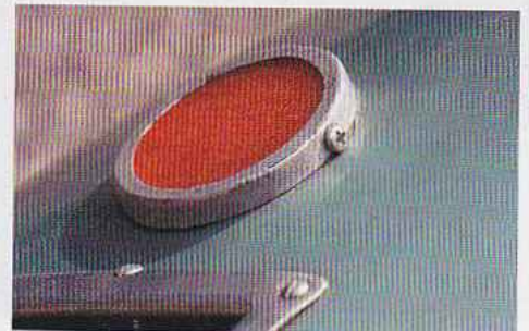
...und die handgefertigten, hauchdünnen Rückleuchtenrahmen. Die Lichtscheiben selbst sind aus rot gefärbtem Kunstharz gegossen
