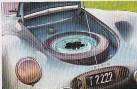
Notration für die Rom-Reise: Der sehr flache Kofferraum im Bug wurde ursprünglich durch zwei Reserveräder vollständig ausgefüllt
