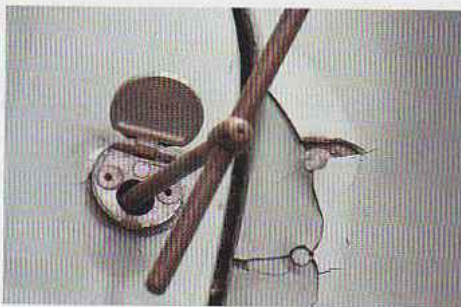
Leichtbau in Höchstform: Viele Details am 64, sogar Schaltbock und Lenkradnabe, sind aus Alu – natürlich auch die Haubenverschlüsse...
