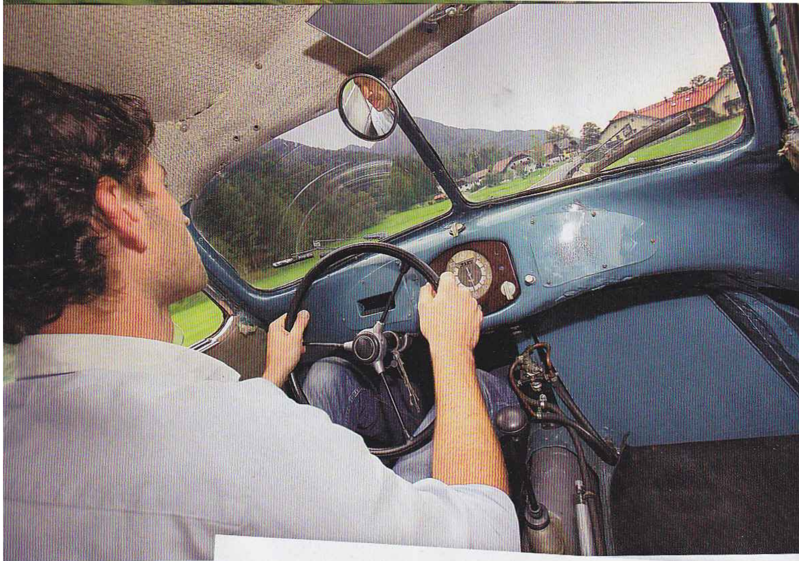
Raumsparmodell: karge Typ-64-Zelle mit Benzintank im Fußabteil des Beifahrers
